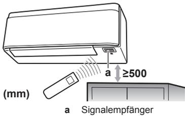
**Hinweis:** Sorgen Sie dafür, dass sich im Bereich von 500 mm unterhalb des Signalempfängers keine Hindernisse befinden. Die Empfangsleistung der Benutzerschnittstelle könnte dadurch beeinflusst werden.
