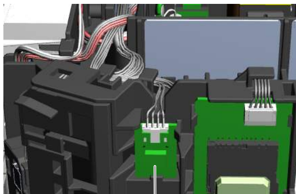
a Platinenbaugruppe des Feuchtesensors
